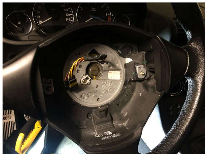
Bevor das Lenkrad abgezogen wird, sollte es in Mittelstellung gedreht, so dass die Räder geradestehen und die Lage von Lenkrad zu Lenksäule mit einem Filzstift markiert werden.
