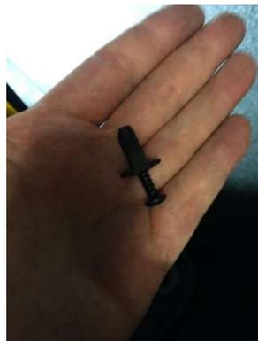
Die Verkleidung ist nach dem Entfernen der Schraube nur noch geklippt.
