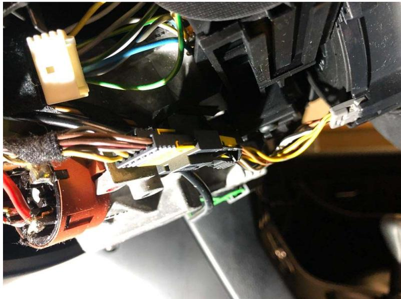
Von der hinteren Seite des Lenkrads die zwei Innentorx lösen. Ich glaube, es war ein T30. Bei der ersten Schraube merkt man schon, dass der Airbag sich löst.
