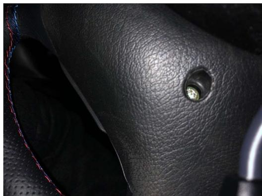
Auch hier den Stecker mit Buchse aus der Klemme nehmen und lösen. Danach den Airbag entnehmen und mit der schwarzen Lederseite nach oben gut weglegen:
