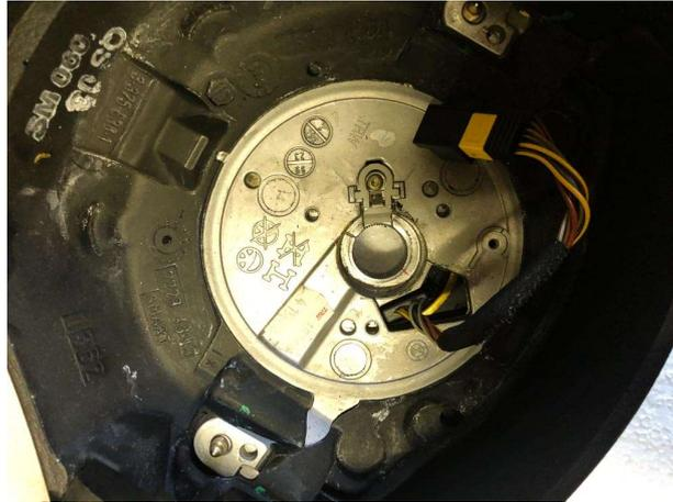
Danach das Lenkrad umdrehen und die drei kleinen Schrauben am Schleifring entfernen.
