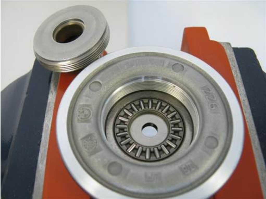
Die obere Lagerscheibe entfernen (Magnetheber). Anmerkung: Die Scheibe klebt oft mit Öl an dem Schraubendeckel und kommt mit diesem heraus.
