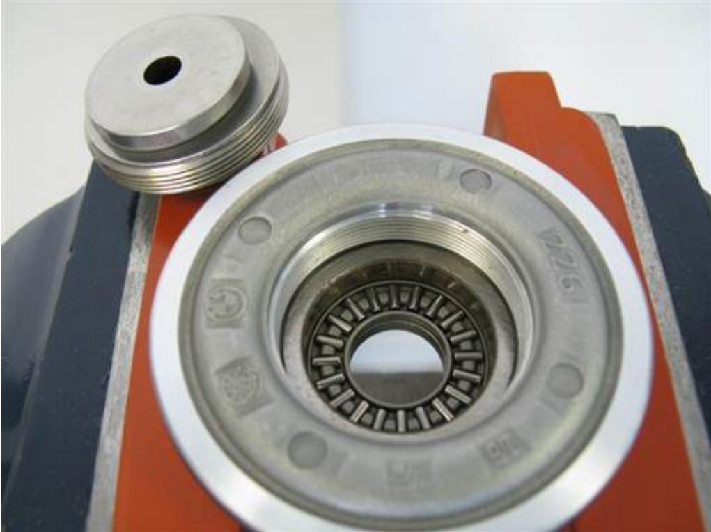
Die mittlere Lagerscheibe entfernen (Magnetheber).
