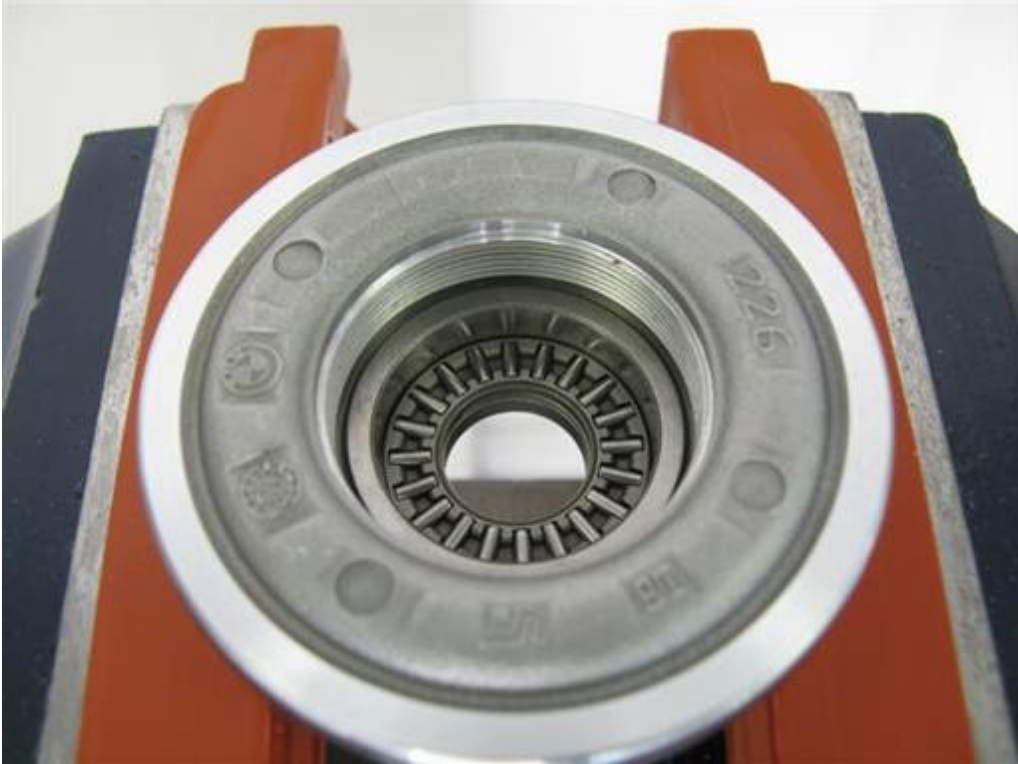
Das untere Rollenlager in den Lagerring einsetzen. Anmerkung: Das obere und untere Rollenlager ist austauschbar. Auch die Seiten des Rollenlagers sind funktional gleich, daher können die Lager in jeder Lage eingebaut werden.
