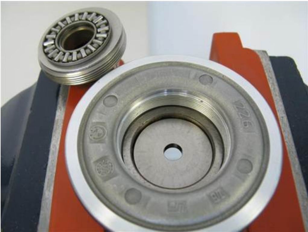
Das obere Rollenlager entfernen (Magnetheber).
