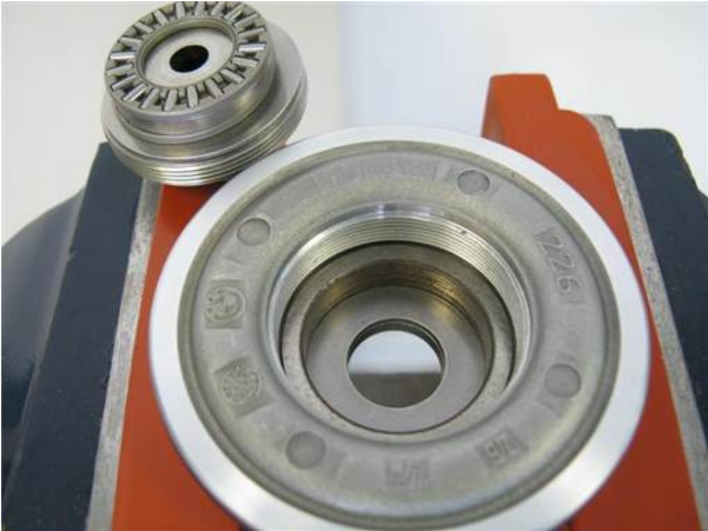
Das untere Rollenlager entfernen (Magnetheber).
