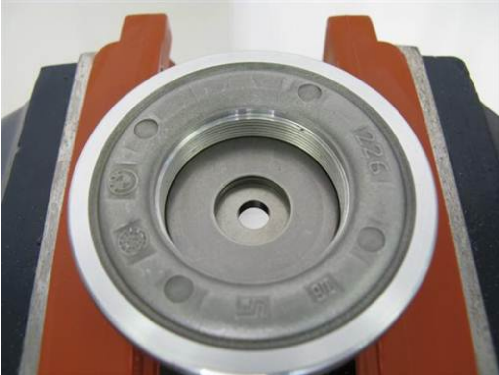
Die obere Lagerscheibe oben auf dem Lagerring einsetzen. Anmerkung: Die Seiten der Scheibe sind gleich, daher kann die Scheibe in jeder Lage eingebaut werden. Die Scheibe leicht nach unten drücken und hin und her bewegen bis sie richtig eingesetzt ist (Finger).
