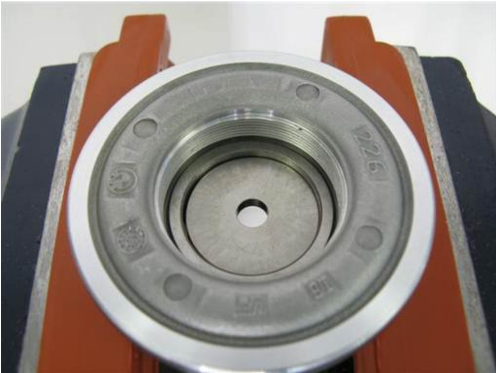
Die mittlere Scheibe in den Lagerring des Kolbens einsetzen. Anmerkung: Die Seiten der mittleren Scheibe sind gleich, daher kann die Scheibe in jeder Lage eingebaut werden.
