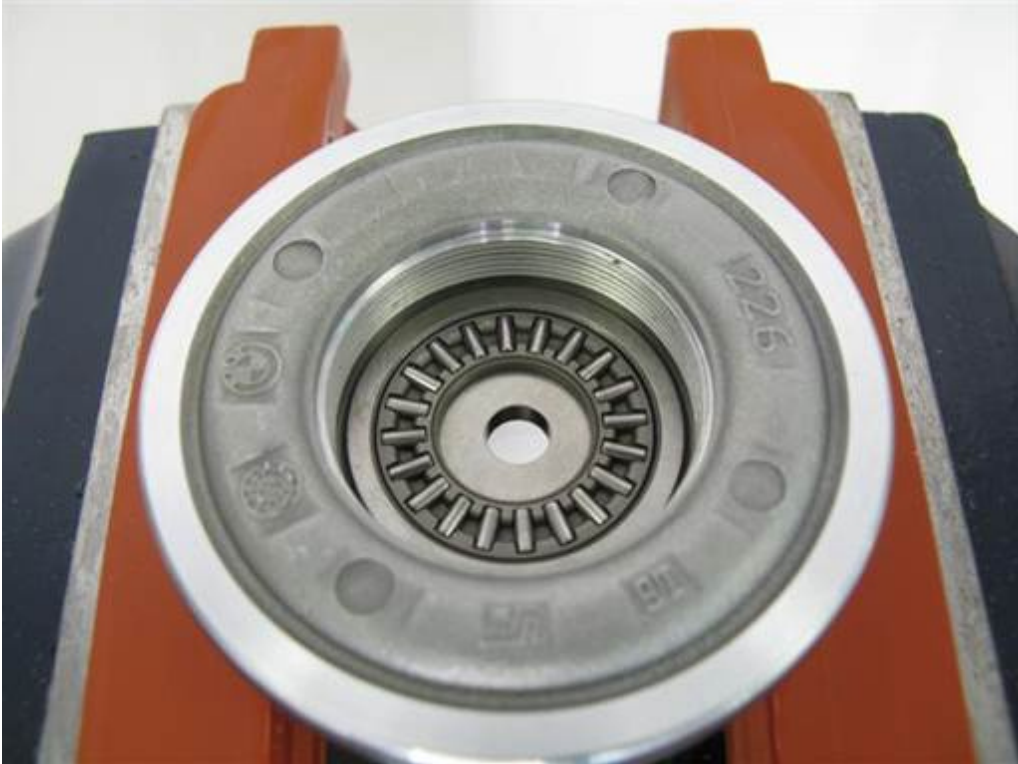
Das obere Rollenlager in den Lagerring einsetzen. Anmerkung: Die Seiten des Rollenlagers sind funktional gleich, daher können die Lager in jeder Lage eingebaut werden.
