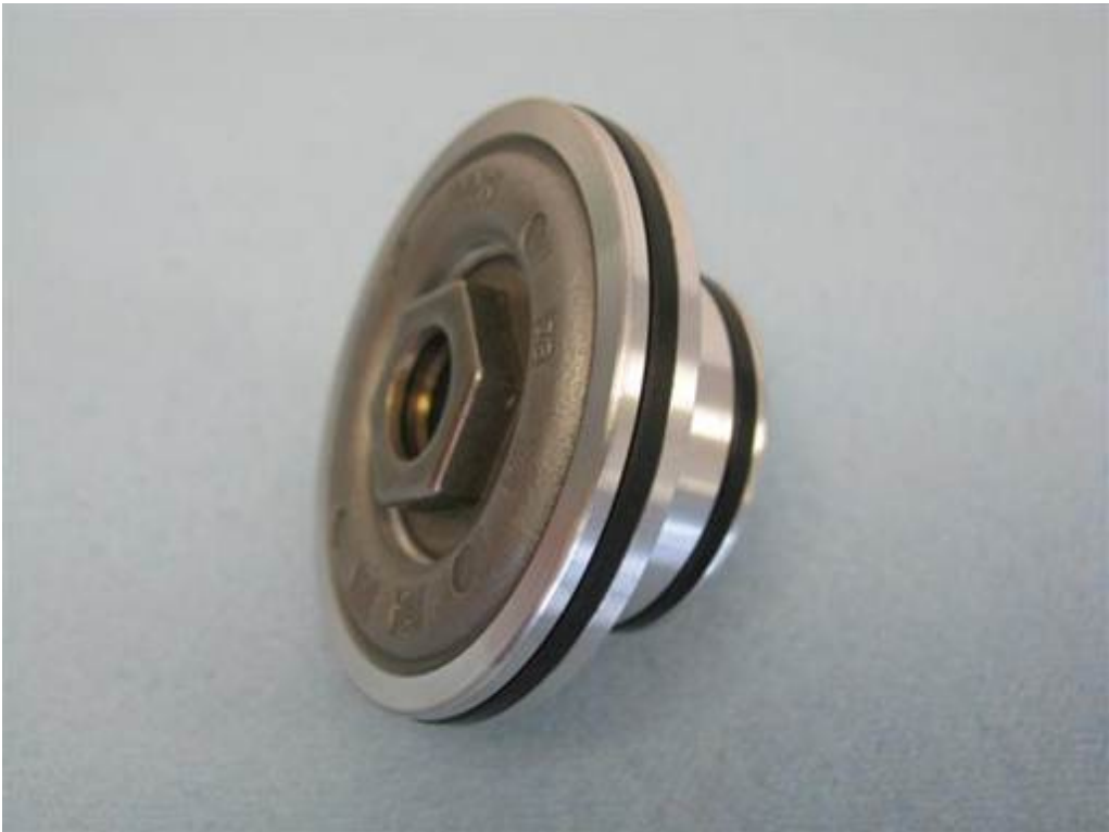
Den Vanoskolben reinigen (Bremsenreiniger & Tücher).
