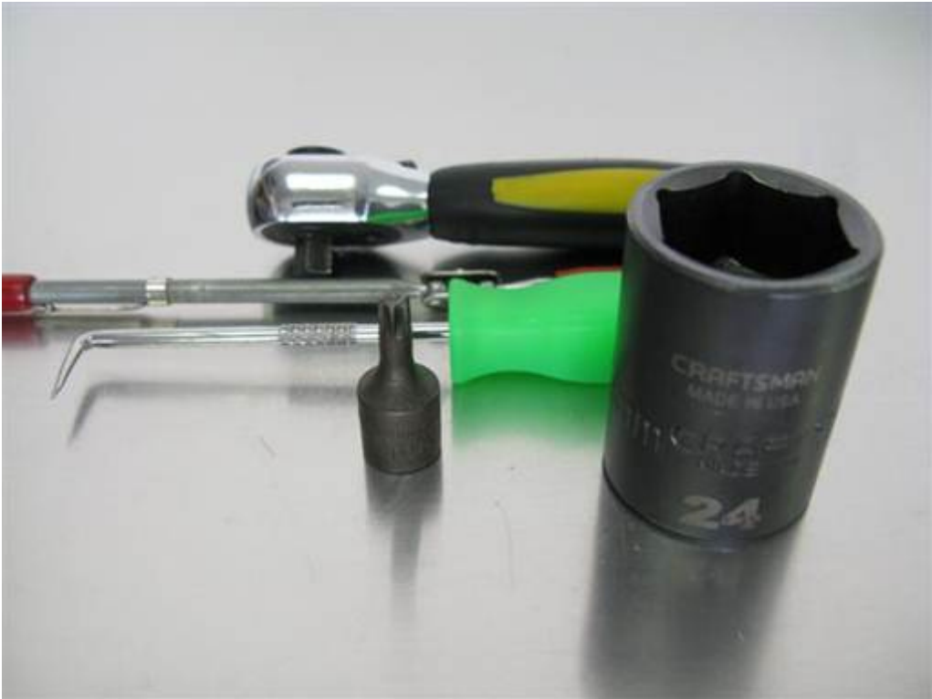
24mm Schlagschraubernuss 1/2", T30 Torx Bit Nuss 1/4", 90 Grad Haken, Magnetheber, 1/4" Ratsche
