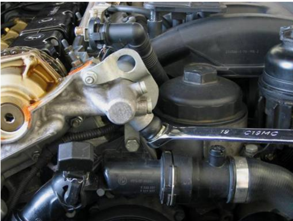
Die Vanos Ölleitung und Hohlschraube abschrauben (19mm Ringschlüssel). Anmerkung: Dort sind 2 Dichtringe, auf jeder Kontaktseite des Schlauchanschlusses eine. Dichtringe wegwerfen.
