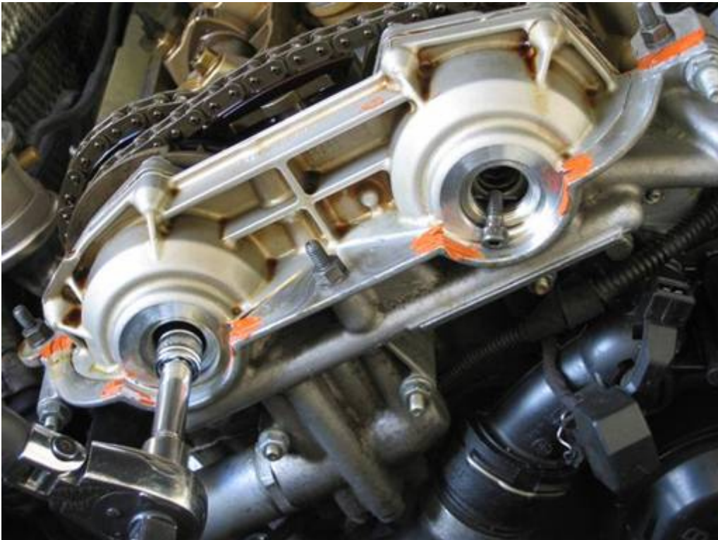
Die 2 Vanos-Kolben/Zahnwellen Schrauben rausschrauben, Linksgewinde (T30 Torx Bit Nuss 1/4" / 1/4" Ratsche & Verlängerung, Magnetheber).
