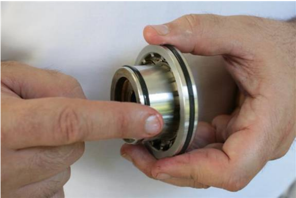
Einen Schmierfilm (Motoröl) auf den kleinen Vanos Teflonring und die anliegende Kolbenoberfläche auftragen.
