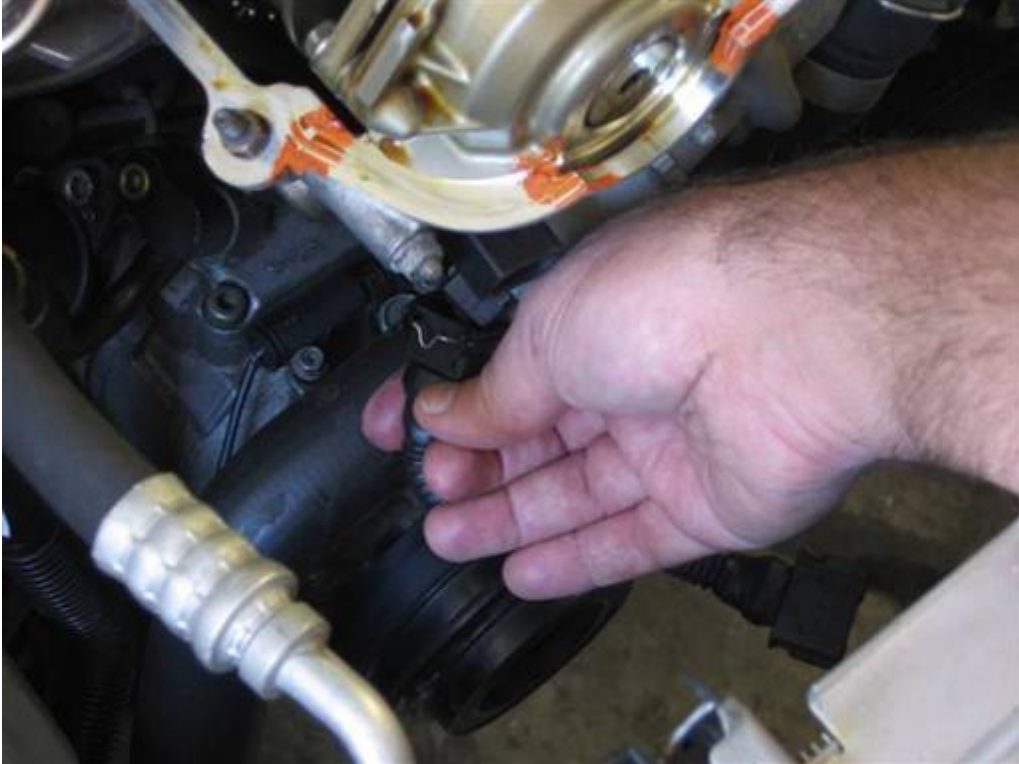
Den Stecker des Vanos Auslass Magnetventils abziehen. Die Metallklammer eindrücken und den Stecker abziehen.
