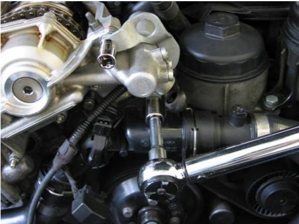
Anmerkung: Erst den Kabelbaum zur Motorseite verlegen, bevor die Motorhalterung montiert wird. Befestigen des Motorhalters am Vanos-Einlass-Magnetventil. Das obere Loch auf den oberen Motor-Gewindebolzen stecken, dann den Halter nach unten vor das Thermostat drehen. Die obere Mutter montieren (11mm Nuss 3/8" / 3/8" Ratsche & Verlängerung) und die untere Schraube mit Unterlegscheibe (13mm Nuss 3/8" / 3/8" Ratsche & Verlängerung) Fest ziehen, 10Nm (11mm Nuss 3/8" & 13mm Nuss 3/8" / 3/8" Drehmomentratsche & Verlängerung).
