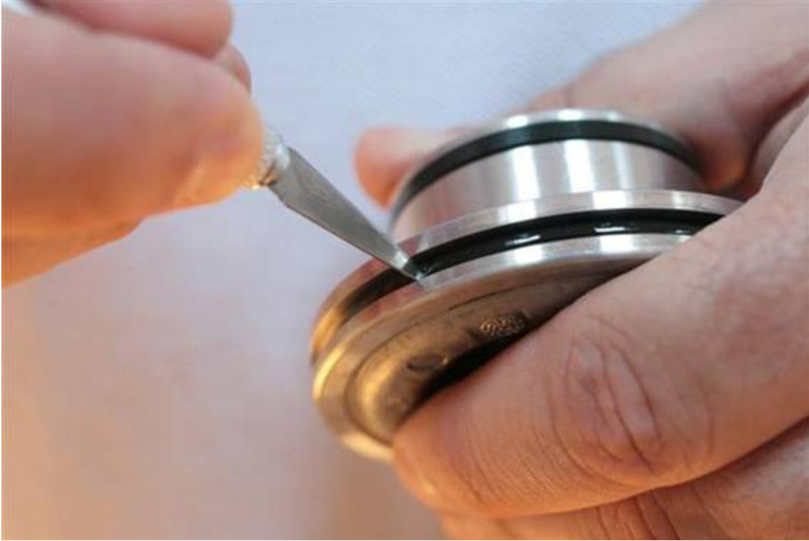
Den großen O-Ring in der Kolbennut quer durchtrennen (Skalpell). Anmerkung: Wackeln der Klinge während des Drückens hilft bei der Schneidbewegung.
