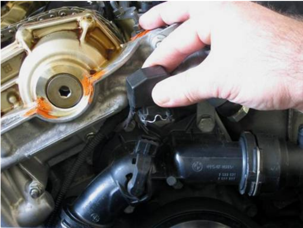
Den Stecker des elektrischen Thermostats abziehen. Die Metallklammer eindrücken und den Stecker abziehen.
