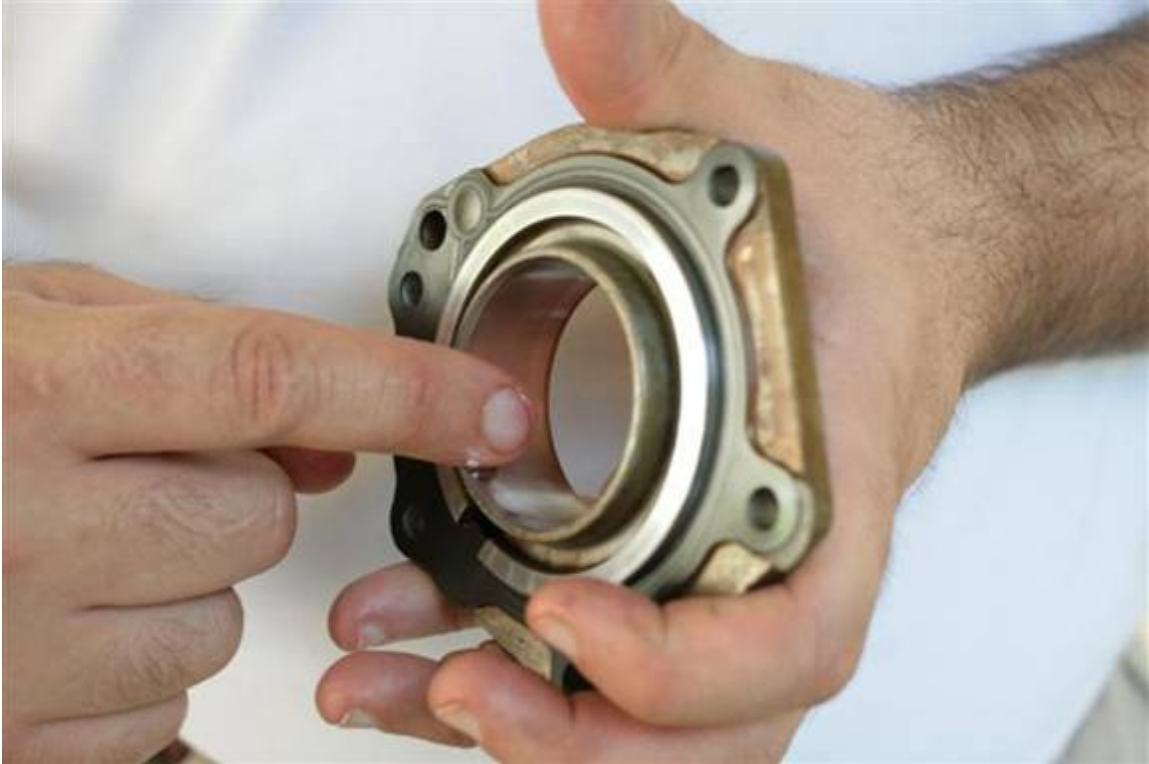
Einen Schmierfilm (Motoröl) auf die Zylinderwand des Vanos-Deckels auftragen. Auch auf die abgeschrägte Kante (Kanten-Fase).
