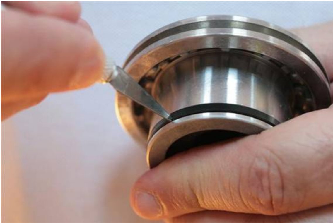
Den kleinen Teflonring in der Kolbennut quer durchtrennen (Skalpell). Anmerkung: Wackeln der Klinge während des Drückens hilft bei der Schneidbewegung.
