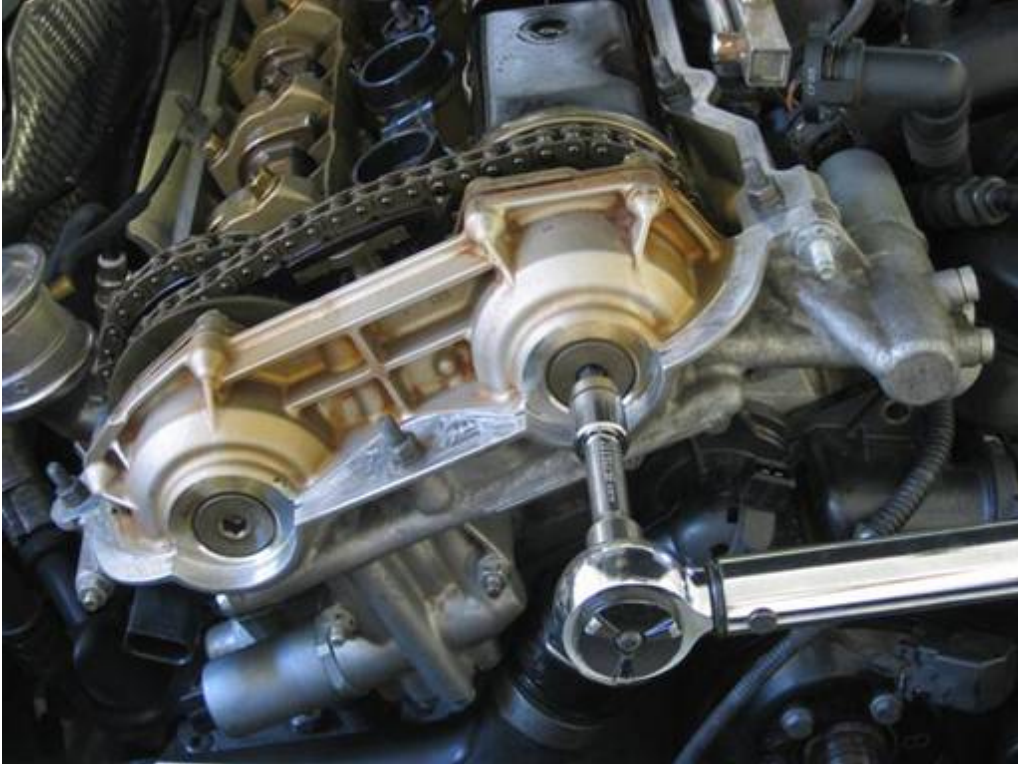
Die 2 vorderen Vanos Zylinder Abdeckschrauben mit Scheiben einschrauben (8mm Inbusnuss 3/8" / 3/8" Ratsche & Verlängerung). Fest ziehen, 50Nm (8mm Inbusnuss 3/8" / 3/8" Drehmomentratsche & Verlängerung).
