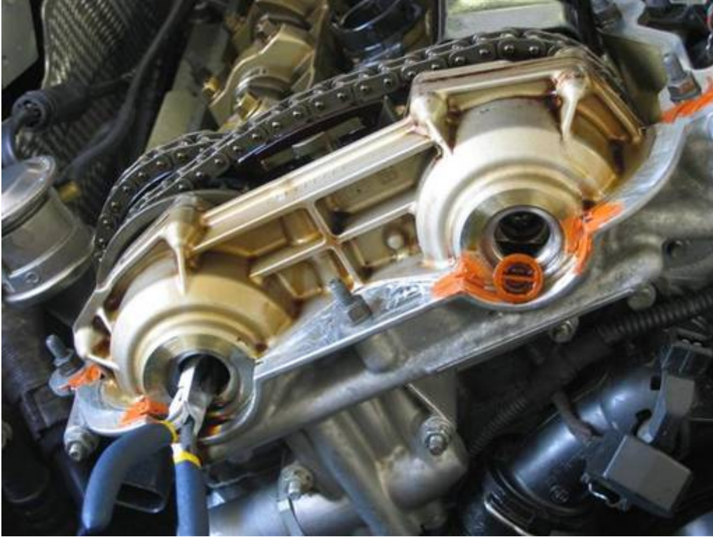
Die 2 Vanos-Kolben-Kappen herausziehen (kleine Spitzzange).
