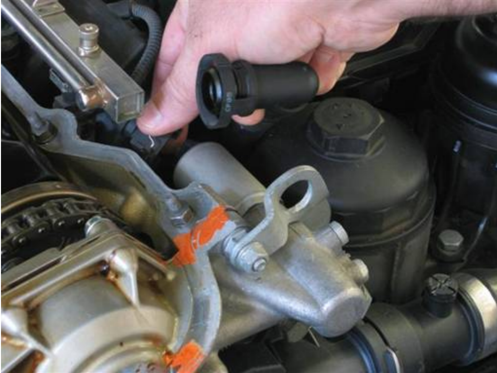
Den Stecker des Vanos Einlass Magnetventils abziehen. Die Metallklammer eindrücken und den Stecker abziehen.
