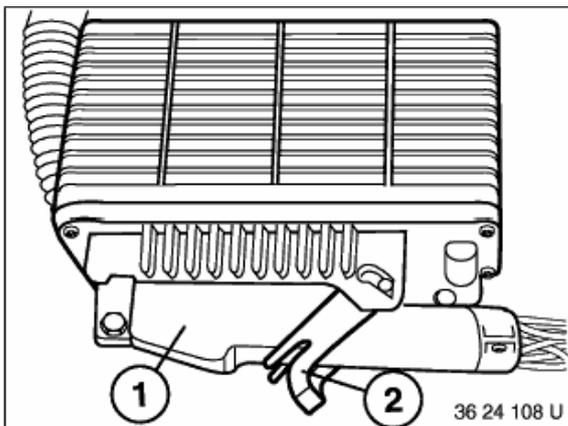
Stecker (1) vom Steuergerät abziehen, dazu Haltefeder (2) nach unten schwenken.
