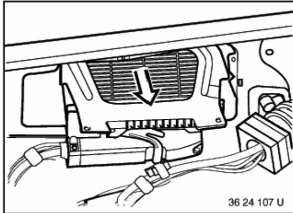
Steuergerät durch die Öffnung nach vorne herausziehen.
