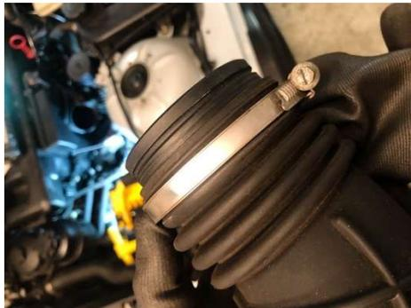
Luftfilterkasten mit LMM und erstem Faltenbalg/Rohrkrümmer aus dem Motorraum nehmen.
