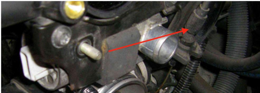
und den Gaszug an der rechten Seite der Drosselklappe nach hinten ausgehängt. Achtet für den späteren Zusammenbau, auf die Führung.
