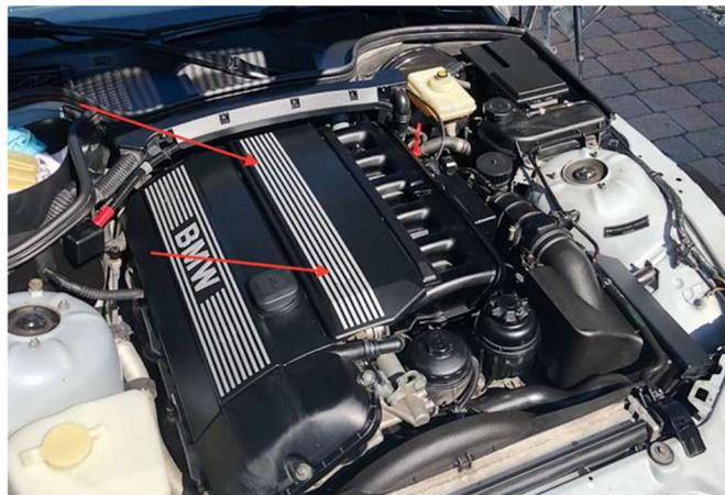
Kleinen Unterdruckschlauch vom Benzindruckregler ziehen und dicken Plastikschlauch vom Ventildeckel ziehen, dazu an zwei Seiten zusammendrücken:
