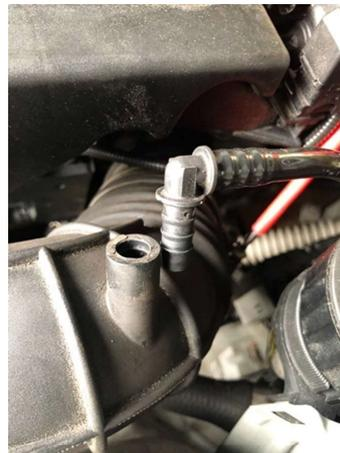
Schelle nach erstem Faltenbalg lösen. Bei mir waren dort zwei Schellen. Eigentlich braucht nur eine der beiden gelöst werden, da hier nur ein Verbinder/Adapter zwischen den zwei Schläuchen eingebaut ist und es reicht nur eine Seite zu trennen.
