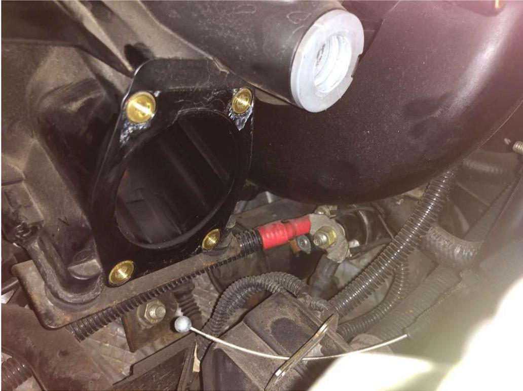
Links neben der Drosselklappe sieht man nun das Kurbelgehäuseentlüftungsventil, rechts ist noch der Steckerbuchse des Leerlaufreglers zu sehen.
