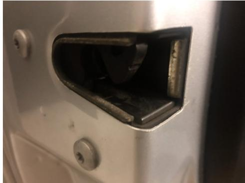
Wenn man nun mit der Hand in den Bereich geht, wo der Stellmotor hinkommt und den Türkopf nach unten drückt, bewegt sich der mittlere Riegel (drei Bilder höher, mittlerer gelber Pfeil). Damit wird einem ein wenig klar, welcher Riegel in den Stellmotor kommt. Dieser Riegel wird also vom Stellmotor automatisch bewegt.
