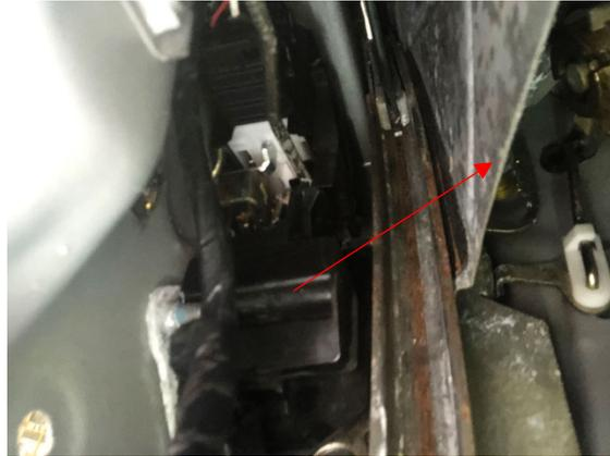
Linker Bereich Stellmotor (das kleine weiße Etwas) und rechts der Bereich des Schlosses.
