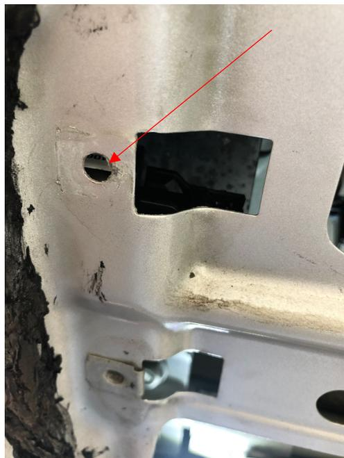
Ich habe leider kein besseres Bild, als das nächste. Der Pfeil zeigt auf ein Blech (ich glaube es ist der Diebstahlschutz gegen Aufhebeln), welches die Tür ein wenig teilt. Zum einen in den Bereich des Türschlosses und zum anderen in den Bereich des Stellmotors. Dieses Blech ein wenig nach außen drücken. Man erhält dadurch mehr Spielraum für die Hand, wenn man versucht an den Stellmotor zu kommen.
