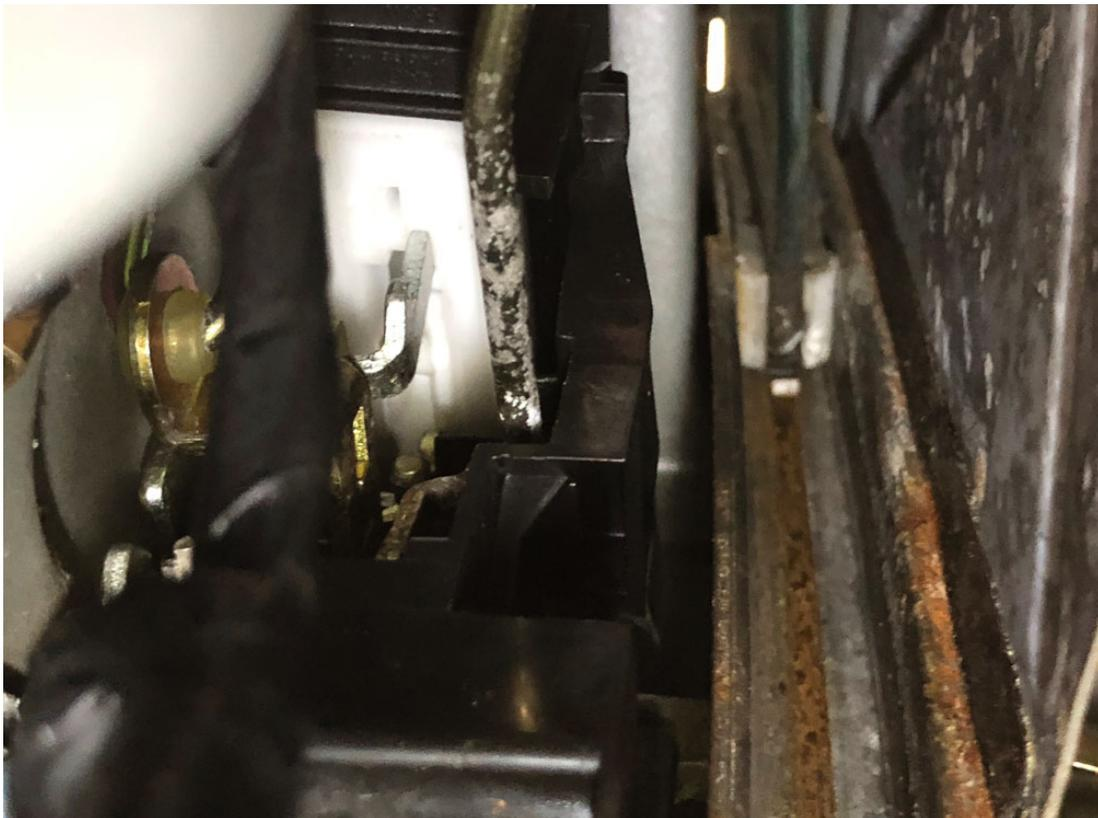
Nun versuchen, die Riegel/Laschen richtig in die Löcher des Stellmotors zu bekommen. Ist nicht einfach und Geduld ist gefragt. Wenn sie sitzen, durch Kippen und herunterdrücken des Stellmotors versuchen, dass der Stellmotor noch in den Haken einrastet. Das hat bei mir lange gedauert, bis er richtig saß.
