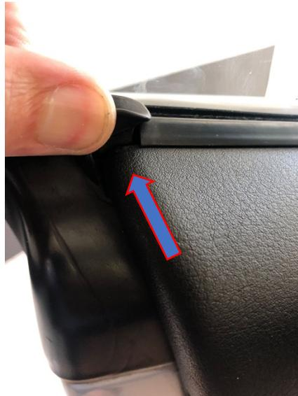
Die Türverkleidung sollte nun bis auf oben komplett lose sein (Achtung, innen sind noch die Lautsprecher verkabelt). Die Verkleidung unten ein wenig abheben und nach oben aus der Tür herausziehen. Eventuell kommt die Dichtung zwischen Verkleidung und Fenster mit raus. Nicht schlimm, sie kann später leicht wieder eingesetzt werden.
