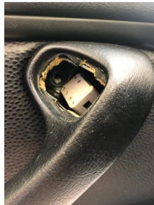
Dahinter befinden sich zwei Schrauben, diese mit einem Steckschlüssel rausdrehen.
